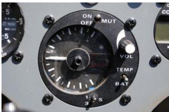
Rechts unten vom Variometer befindet sich ein Instrument, das optisch fast genauso aussieht und auch praktisch die gleiche Funktion hat. Es ist das elektronische Variometer das einen etwas anderen Hintergrund hat. Zusätzlich gibt es hier die Möglichkeit, das Steigen bzw. Sinken durch einen Ton zu simulieren. So muss der Pilot nicht
