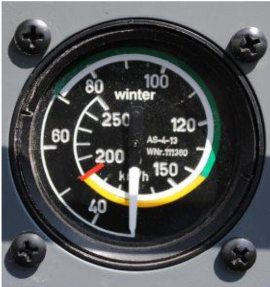
Rechts oberhalb davon befindet sich der sogenannte Fahrtmesser. Er ist ungefähr vergleichbar mit dem Geschwindigkeitsmesser im Auto. Der einzige Unterschied ist, dass im Auto die Geschwindigkeit gegenüber dem Boden gemessen wird, welcher als Groundspeed bezeichnet wird. Im Segelflugzeug wird die Geschwindigkeit gegenüber der umliegenden Luft gemessen, die je nach Windstärke anders sein kann, als über dem Boden. Sie wird Indicated
